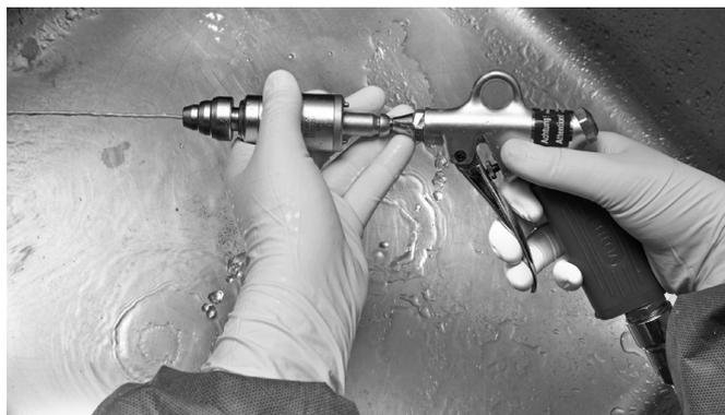
**7. Inspeção visualmente o dispositivo.** Inspeção a existência de sujeira visível nas canulações, mangas de acoplamento, etc. Repita as etapas 1 a 7 até que não seja visível qualquer sujeira.
