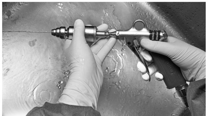
**7. Desinfecção com toalhete/spray.** Limpe as superfícies dos dispositivos com um toalhete ou spray com um desinfetante à base de álcool a 70%, no mínimo.
