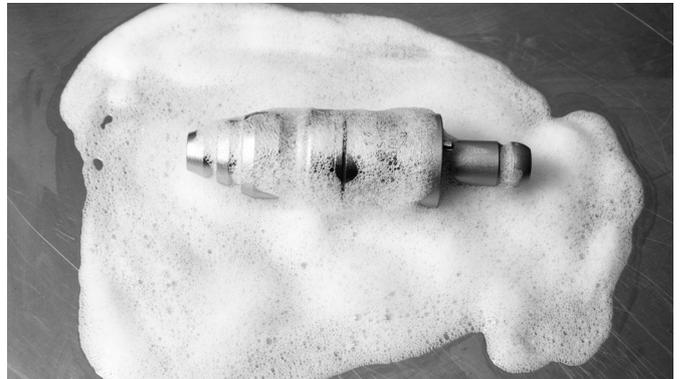
**4. Enxague com água da torneira.** Enxague o dispositivo com água fria da torneira durante um mínimo de 2 minutos. Utilize uma seringa ou pipeta para irrigar lúmenes e canais.
